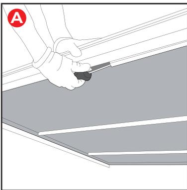
Con el portón trasero abierto, presione hacia abajo la cubierta y gire la perilla debajo.
