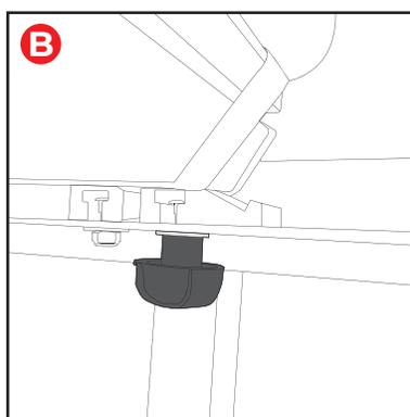
Con la compuerta trasera abierta, enganche el cabezal de la parte trasera de la carpa en los topes de cabecera a ambos lados del vehículo.
