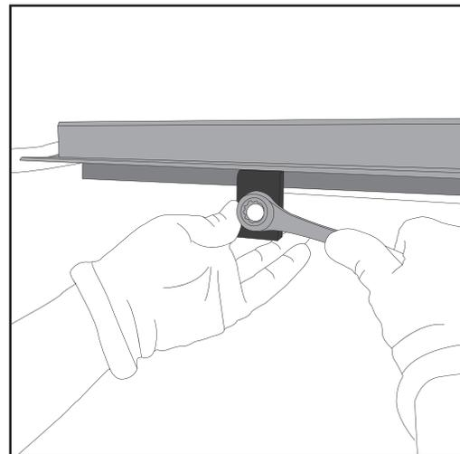
2. Coloque la carpa detrás de la ventana trasera e inserte los tornillos en los orificios de los rieles laterales como se muestra en la imagen.
