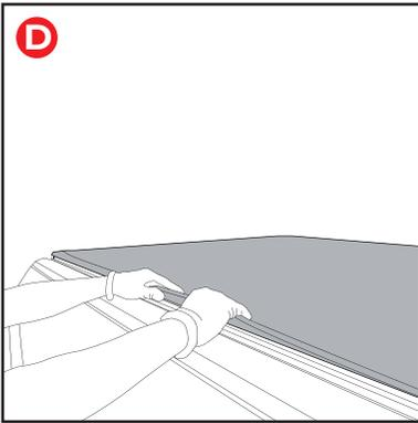
Tiempale bien el velcro en los rieles laterales y presione el velcro de la cubierta a todo lo largo para que asegure bien.
