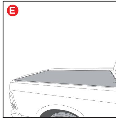
Tiempale la cubierta con fuerza a lo ancho del platón de la camioneta en el lateral opuesto.
