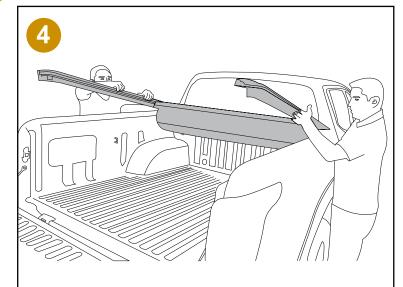
Enrolle la Cubierta en la caja y apriete firmemente la chapa hasta que esta asegure. Entre 2 personas coloque la cubierta sobre el borde del platón que da contra la cabina y asegúrese que el empaque que queda contra la cabina no se doble hacia adentro.
