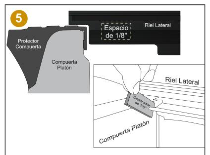
Asegure la Cubierta: Mueva los rieles hacia adelante o hacia atrás para lograr un espacio de 1/8" o 3 mm entre la muesca inferior del riel y la cara interior de la compuerta trasera o el protector plástico de la compuerta trasera. Mida ambos lados. Use el separador de 1/8" de grosor suministrada para lograr contar con ese espacio.
