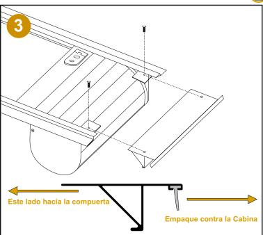
La tapa se asegura por debajo de los rieles. Para esto deslícela en su lugar como se muestra en la figura. Cuando esté alineada, atornille usando los tornillos suministrados y asegure usando una llave bristol de 5mm. Asegúrese que durante la instalación, el empaque final de la tapa no se doble hacia adentro, ya que puede ponerse muy dificil para mover. Este empaque deberá sentar sobre el borde del platón. Normalmente este empaque se envía más largo de lo normal, para que sea cortado a la medida.
