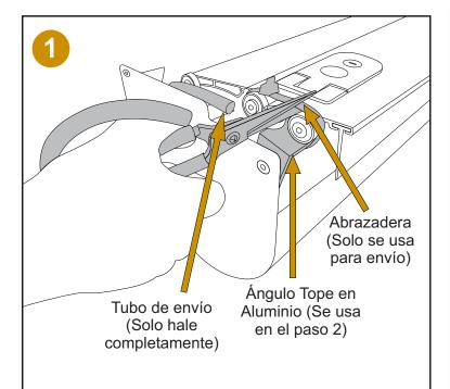
Corte la abrazadera con una tijera o bisturí y luego retire la pieza en aluminio que está asegurada con un tornillo directamente a la caja.
