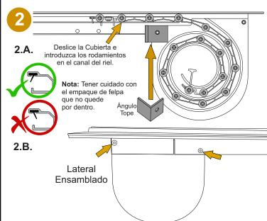
Ensamble el riel lateral a los caracoles de la Cubierta e instale el ángulo tope que retiró en el paso 1.
