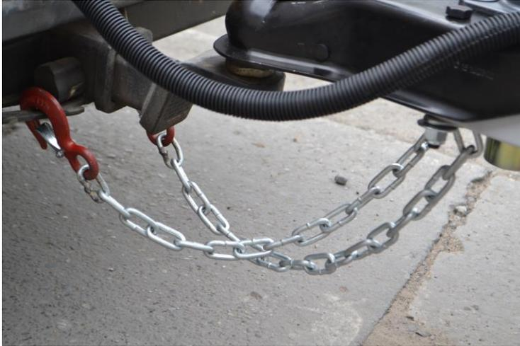
Figura 10: Cadenas de Seguridad
