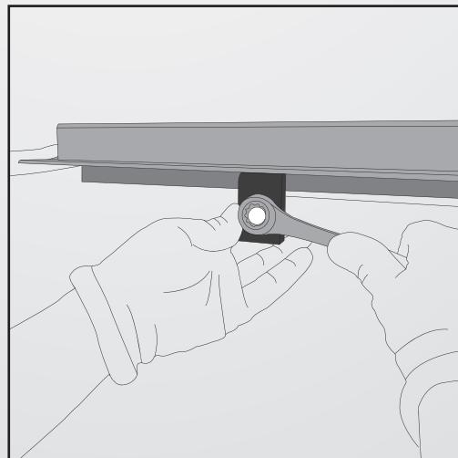
**2.** Coloque la carpeta detrás de la ventana trasera e inserte los tornillos en los orificios de los rieles laterales como se muestra en la imagen.
