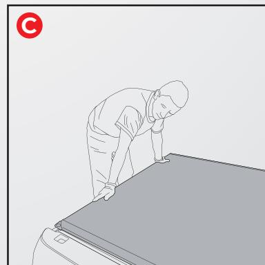
Gire el cabezal de la puerta trasera hacia abajo hasta que ambos pestillos encajen. Escuche el doble clic.
