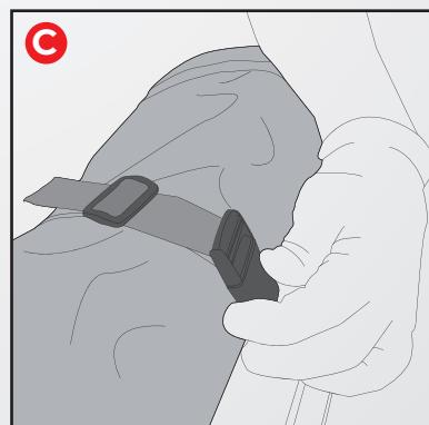
Asegure siempre la cubierta en la parte delantera de la camioneta con las correas de seguridad cuando la cubierta está abierta.
