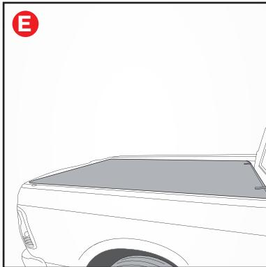
Tiemple la cubierta con fuerza a lo ancho del platón de la camioneta en el lateral opuesto.
