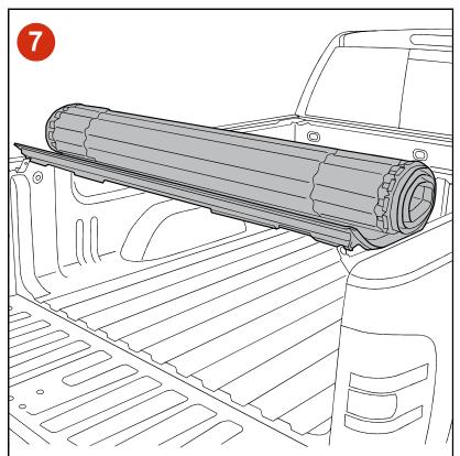
Con ambos rieles instalados en su lugar, coloque la cubierta sobre el lado de la compuerta (sin cerrar el mecanismo de la chapa), y desenrolle hacia adelante hasta que encuentre los soportes de montaje ubicados en cada lateral en forma de ranura.
