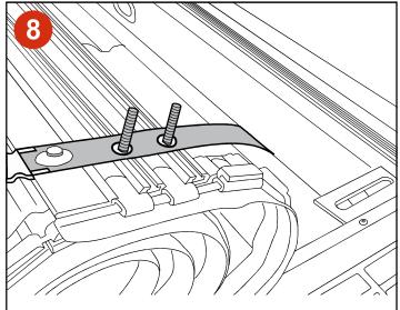
En la parte frontal de la cabina, desenrolle la cubierta hacia atrás e inserte los tornillos de montaje a través de las ranuras que trae el perfil de aluminio.
