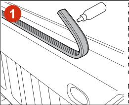
Si lo trae: Instale el empaque de caucho en la parte frontal del platón y contra la cabina del vehículo. Si la camioneta tiene Protector Plástico asegúrese que el mismo no interfiera para la entrada de agua.
