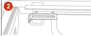
Coloque el riel de la Cubierta con el soporte que trae una ranura contra la cabina así como se muestra en la figura. Este soporte es el que sostendrá y asegurará la cubierta como tal.
