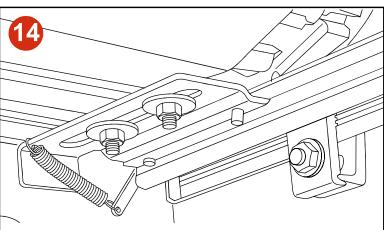
Una vez alineada apropiadamente, enrolle la cubierta asegurándose de NO desalinear la Cubierta. Apriete ambas tuercas y ambos lados. Revise de nuevo que funcione correctamente la cubierta. Cuando cierre la chapa, cerciorese que los rieles de bloqueo dentro del riel lateral eviten que la cubierta se pueda levantar por cualquier lado.
